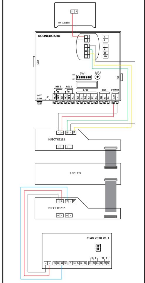
**PRÉCABLAGÉ USINE PORTIER TYPE ERP (BOUCLE MAGNÉTIQUE)**
